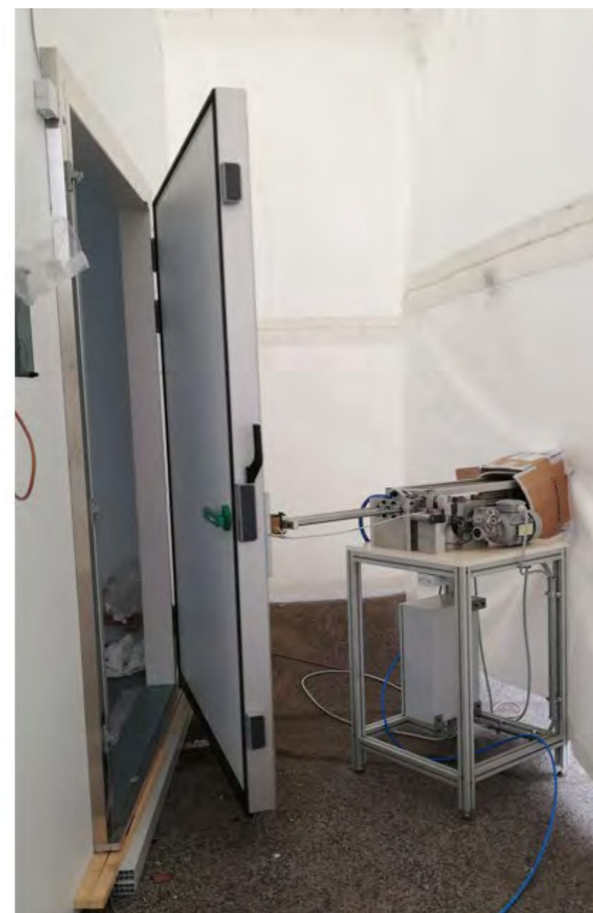
IP / IN / IP-G prova di sollecitazione da 100.000 cicli
