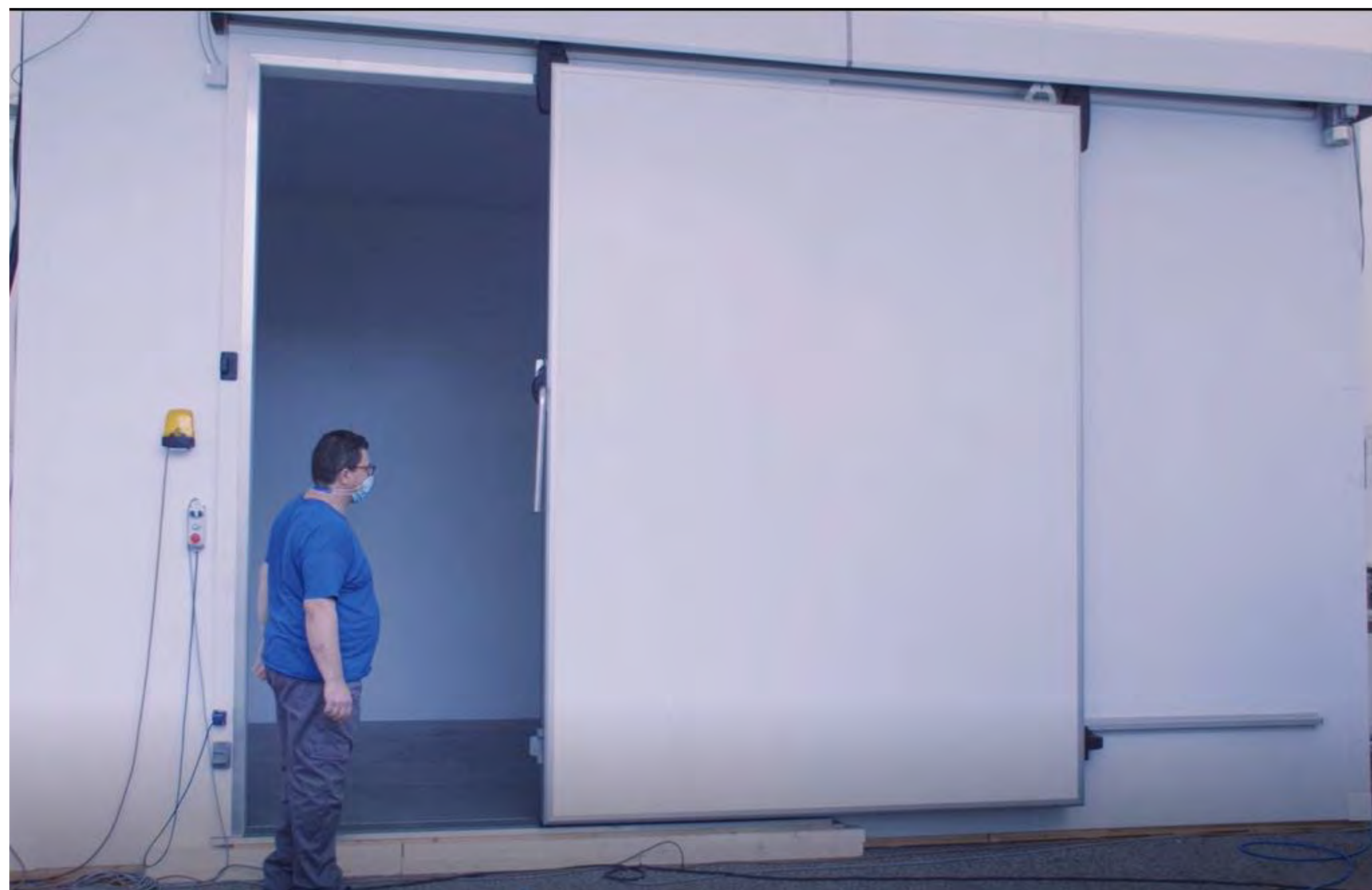
IPS / INS / IPS-G prova di sollecitazione da 100.000 cicli
